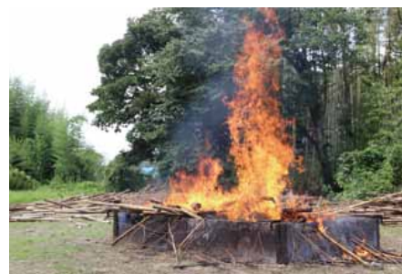
鉄板をつなげてできている炉は、簡単に解体して軽トラで持ち運ぶことができます。竹炭は農家や造園業者へ安価で販売。活動資金としています。
